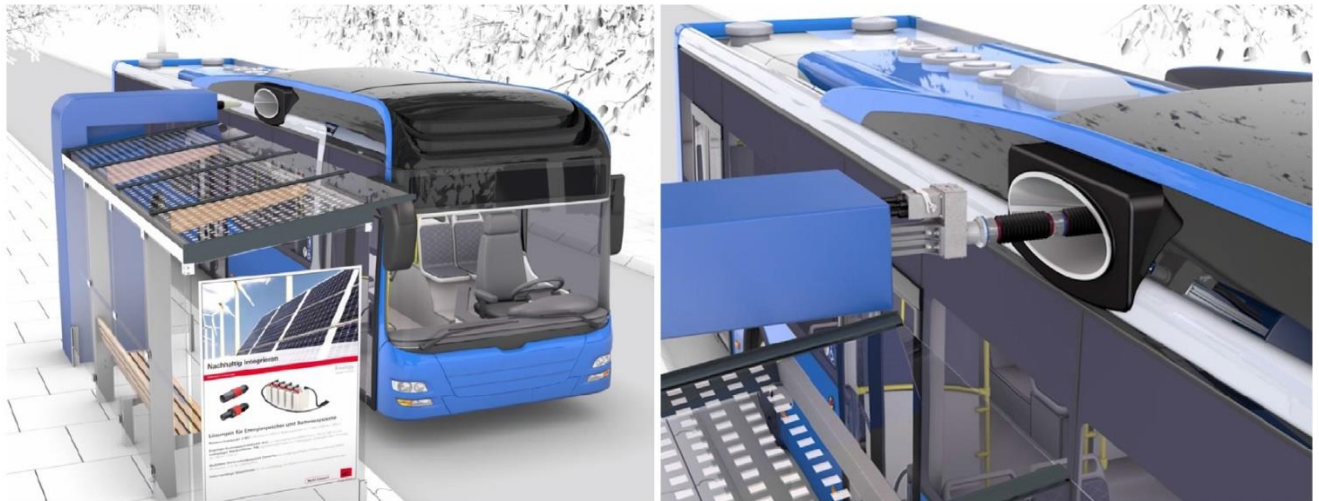
Elektrobus se automaticky dobíjí během pouhých několika sekund na zastávce, kdy získá dostatek energie na další jízdu.
